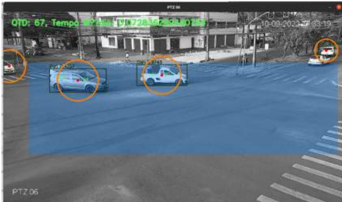
Figura 4-21. Detecção de veículos através de modelo de detecção de objetos. Fonte: Barbado et al. (2022) 1
